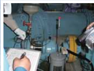
モータ軸受の振動レベル測定 (垂直方向)
